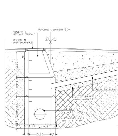
PARTICOLARE POZZETTO ISPEZIONE STRADALE
